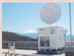
甲府盆地内の気象を観測する高精度レーダー
