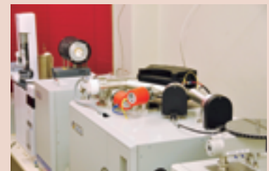
水や汚染物質の起源を探る安定同位体質量分析計
